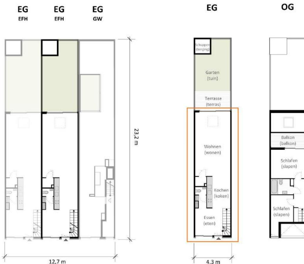
Abb. 16: Grundrisse des aktuellen Einfamilienhauses – Darstellung auf Basis der Architektenpläne – Abweichungen möglich
